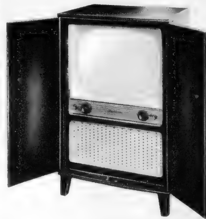
Bild 12. Schaub-Lorenz-Illustraphon 553, ein besonders kleiner Schrankempfänger mit 53-cm-Bildröhre
