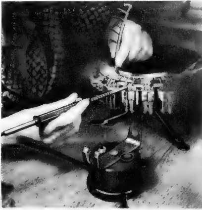
Bild 2. Der auf dem Prinzip der Lötspitze beruhende Mentor-Lötgriffel ist handlich wie ein Kolben
