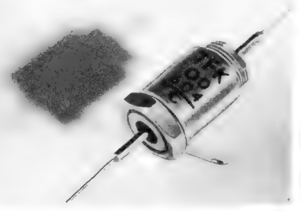
Bild 1. Telefunken 1-W-Leistungstransistor Typ OD 604
